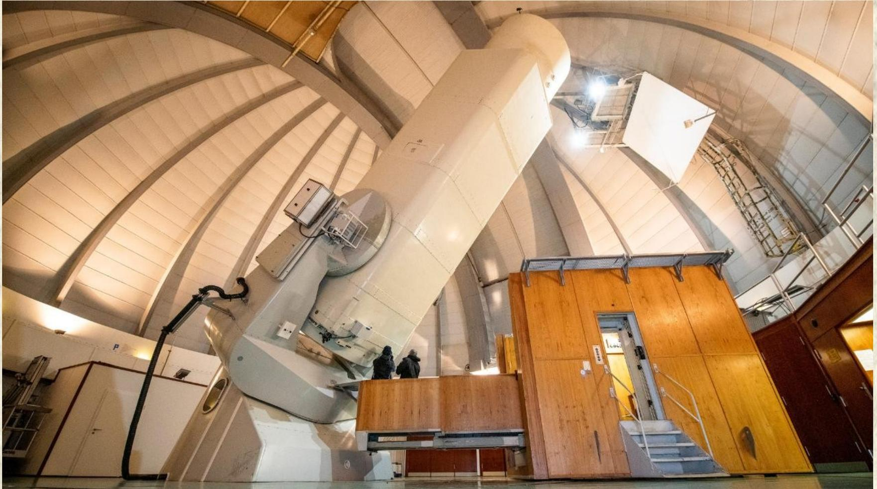
Kuppel mit TAUKAM-Kabinett (links) für Kryoeinheit und Steuerung sowie Führungsschlauch (schwarz) für Kryo-, Elektro/Elektronik- und Glasfaser-Leitungen. Im Tubus befindet sich der TAUKAM-Parkplatz für die Vollmond-Periode (Spektroskopie).
