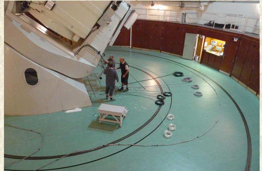
Entgegen Uhrzeigersinn: Kabelverlegung, Kameraentnahme aus Parkposition, am Haltekreuz, Shutter und CCD
